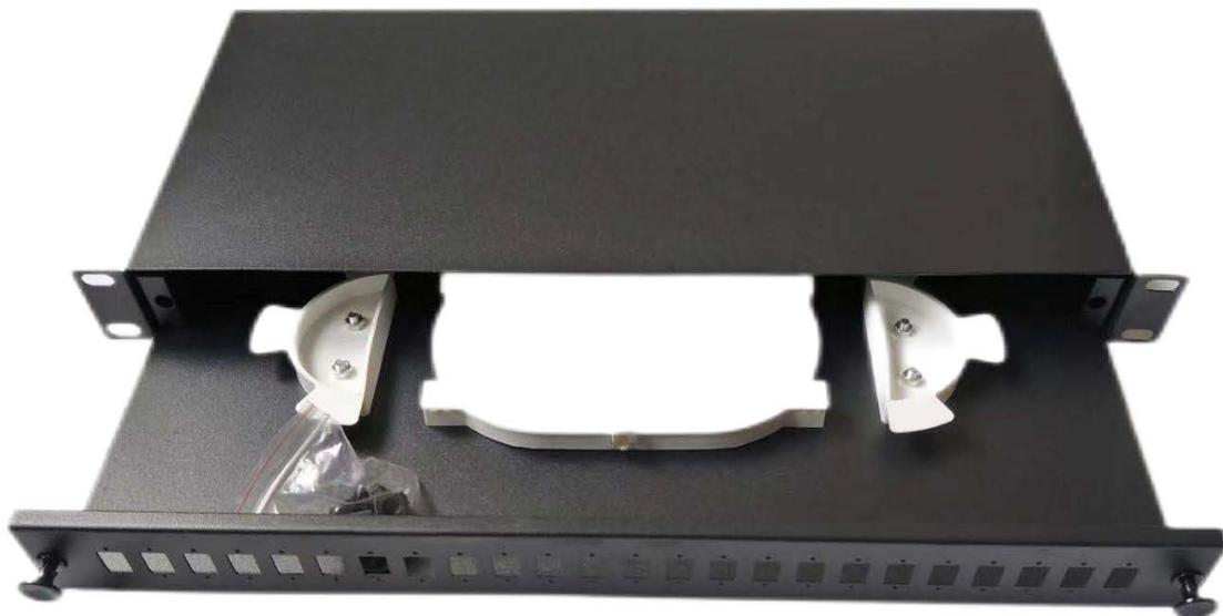
La serie LE-FPP-FDR1U di pannelli di patch per fibra ottica è progettata con un tipo di scorrimento falso. Adatto per essere utilizzato nella connessione di derivazione delle fibre ottiche. Ha una struttura standard da 19 pollici, che è comune per il montaggio su rack in ambienti IT. Inoltre, è progettato per ospitare adattatori di diversi tipi, inclusi FC, SC, ST e LC.
